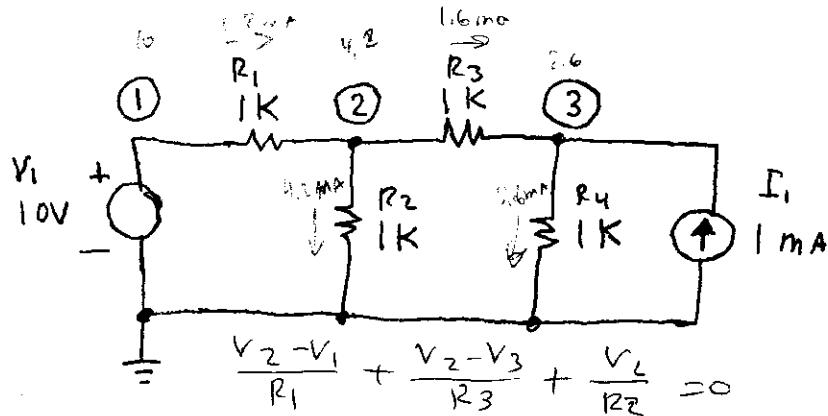
$$\frac{V_2 - V_1}{1k} + \frac{V_2 - V_3}{1k} + \frac{V_L}{1k} = 0$$
